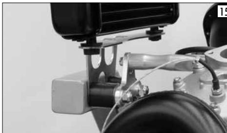
Monter les deux caoutchoucs sur l'étrier et poser le radiateur. Pour fixer le radiateur dans la partie supérieure on fournit un étrier et un caoutchouc; l'étrier devra être ensuite connecté au châssis en utilisant des autres étriers (non fournis) à votre choix.
