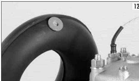
La température EGT relevée en cette position en conditions normales d'usage est entre les 500 et les 620°C, température maximum 650°C.
