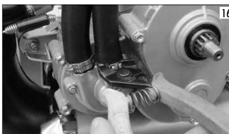
Il est possible de placer le radiateur aussi en bas (schéma B). Pour faciliter le passage de la durite de l'eau sur la culasse on devra utiliser un raccord à 90° ad hoc réf. 928.225.004 (pas fourni) et, si les durites sont trop courtes, il faudra les remplacer et en acheter des nouvelles: durite 16x23 réf 928.230.002 ; durite 10x15 réf. 143.230.001, durite 6x9 réf 928.230.004 vendues par pièces de 1 mètre de longueur.
