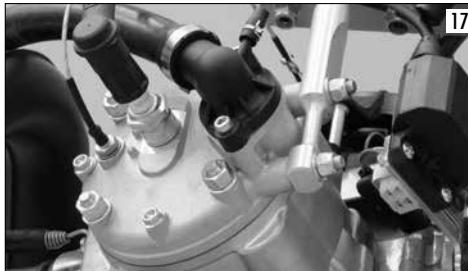
Ces opérations de contrôle du niveau et de purge doivent être répétées après le premier allumage du moteur qui devra être fait en connectant le fil de l'accélérateur au carburateur. Connecter le fil de coupure qui sort de la bobine à un interrupteur connecté à masse. Allumer ensuite le moteur pour quelques secondes. Eteindre le moteur, vérifier le niveau et, si c'est le cas, remplir avec encore avec du liquide.
