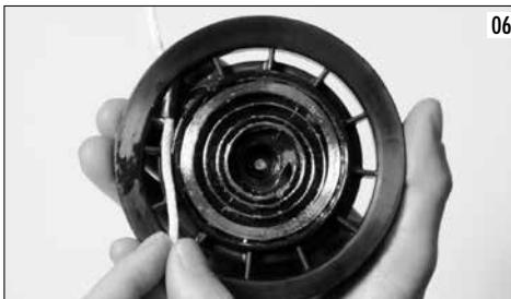
enrouler la corde sur la roue (en respectant le sens d'entrée de la corde sur la roue, photo 7).
