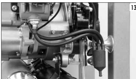
Monter la bougie et le raccord de l'eau sur la culasse à l'aide des deux vis et de l'OR fournis. Placer la bride de fixation de l'hélice et la fixer par son écrou en utilisant une boucle de 19 et bloquer l'écrou avec une clé dynamométrique à 60 N.m. en utilisant du frein filet moyen (photo 14).
