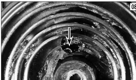
repositionner les ressorts, les doigts d'embrayage démarrage et revisser le couvercle en utilisant du freine fillet moyen.
