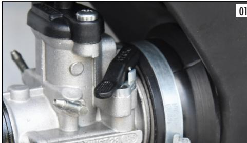
Actionner le démarreur sans accélérer jusqu'à ce que le moteur parte. Une fois allumé, arrêter le moteur, débrancher le starter en le baissant et redémarrer le moteur en accélérant légèrement, si nécessaire. Pour votre sûreté, démarrez le moteur seulement après s'être COMPLÈTEMENT harnaché !
