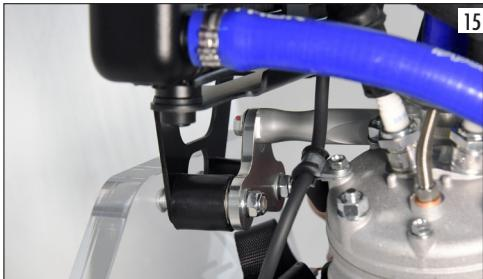
Monter les deux caoutchoucs sur l'étrier et poser le radiateur. Pour fixer le radiateur dans la partie supérieure on fournit un étrier et un petit caoutchouc. A l'aide du collier en acier ad hoc placer et fixer le vase d'expansion du liquide au-dessus du radiateur dans le siège approprié (photo 12). Couper à mesure les durites de l'eau et les monter. Serrer les colliers en dotation en utilisant une pince appropriée (photo 16).
