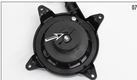
**ATTENZIONE!** Sotto il coperchietto vi sono 2 denti di innesto avviamento (verificarne l'usura ed eventualmente sostituirli) al di sotto degli stessi 2 mollettinghe di dimensioni ridotte. Prestare la massima attenzione per evitare di perdere questi particolari. Preparare il cordino nuovo facendo un nodo ad un capo dello stesso. Rimuovere la ruota in plastica e il vecchio cordino. Infilare il nuovo cordino nell'apposito foro (foto 8),
