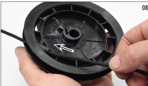
enrouler la corde sur la roue (en respectant le sens d'entrée de la corde sur la roue, photo 9).
