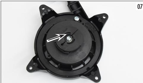
**ATTENTION!** Sous le couvercle il y a deux doigts d'embrayage démarreur (en vérifier l'usure et, si nécessaire, les remplacer) et, au dessous, il y a deux ressorts de dimensions réduites. Prêter attention pour éviter de perdre ces composants.
