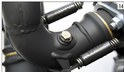
La température EGT en conditions normales d'usage est entre les 500 et les 650°C, température maximum 680°C.
