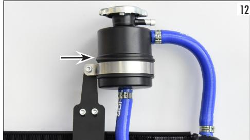
Rabboccare eventualmente il circuito utilizzando del liquido di raffreddamento specifico per radiatori in alluminio.
