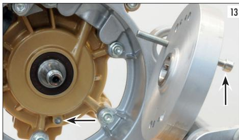
Avvitare il dado del volano senza bloccarlo in modo tale che l'albero motore possa girare nel volano. Avvitare nel foro della candela il supporto del comparatore, posizionare il comparatore e portare il pistone al punto morto superiore. Azzerare il comparatore e ruotare l'albero motore in senso antiorario di 1,7 mm guardando dal lato volano (vedi freccia foto 14).
