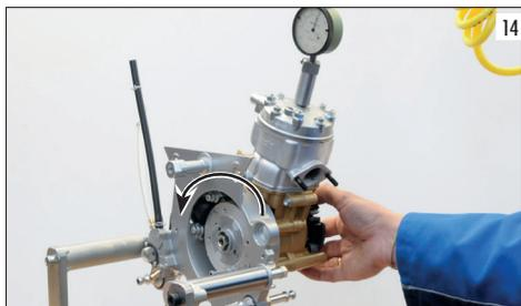
A valore raggiunto, con una mano tenere fermo la puleggia o l'albero motore nella parte opposta e con una chiave bloccare il dado del volano, ma senza eccedere. Riverificare che l'anticipo sia nei valori segnalati ( $1,7 \pm 0,1$ ) togliere le vite m.5x30 e montare la bobina. Prima di bloccarla con le due viti interporre fra bobina e volano uno spessore calibrato da 0,35 mm (foto 15). Procedere al bloccaggio definitivo del dado volano utilizzando una chiave dinamometrica a 40 Nm.
