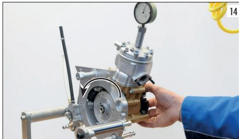
Quand la valeur sera rejointe, fermer la poulie ou l'embellage avec une main dans la partie opposée et, à l'aide d'une clé, bloquer l'écrou du volant, mais sans exagérer.
