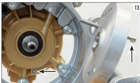
Visser l'écrou du volant sans le bloquer, de façon à ce que l'embellage puisse tourner dans le volant. Visser le support du comparateur dans le trou de la bougie; placer le comparateur et porter le piston au PMS. Remettre à zéro le comparateur et tourner l'embellage dans le sens inverse des aiguilles d'une montre de 1,7 mm du côté du volant (voir flèche photo 14).
