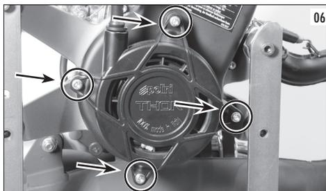
**⚠ ATTENTION!** Sous le couvercle il y a deux dents d'embrayage démarreur (en vérifier l'usure et, si nécessaire, les remplacer) et, au dessous, il y a deux ressorts de dimensions réduites. Prêter attention pour éviter de perdre ces composants.
