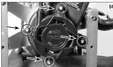
Enlever le nœud de la poignée. Faire attention puisque la poulie centrale tournera jusqu'à la complète décharge du ressort; la tenir et la faire tourner lentement, de façon à éviter quelconque dommage et blessures. Enlever la vis centrale et le couvercle (photo 5).
