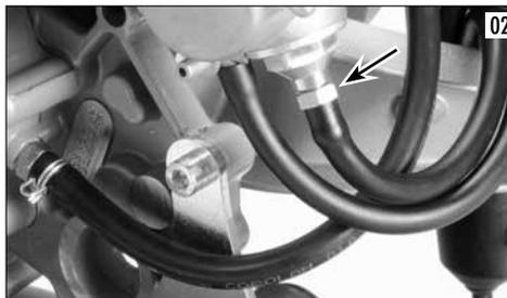
**⚠ ATTENTION:** ne jamais dévisser plus qu'un demi-tour l'écrou de soupirail pour éviter d'endommager le joint de tenue. Ne jamais serrer avec trop de force.
