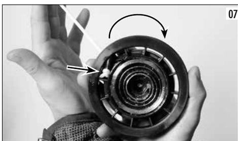
A questo punto inserire nuovamente tutta la ruota in plastica nella sua sede verificando attraverso l'apposito foro che il gancio interno della molla sia perfettamente agganciato (foto 8), riposizionare le molle, i denti di innesto avviamento e riavvitare il coperchio utilizzando frena filetti medio. Tutte le parti in movimento comprese le molle devono essere adeguatamente ingrassate.
