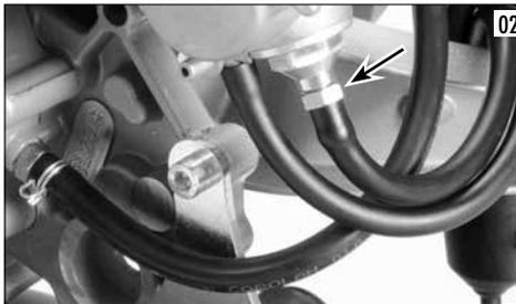
Ri chiudere il raccordo in ottone. A questo punto il carburatore risulta svuotato di tutta la benzina e si può inclinare il motore per il trasporto.
