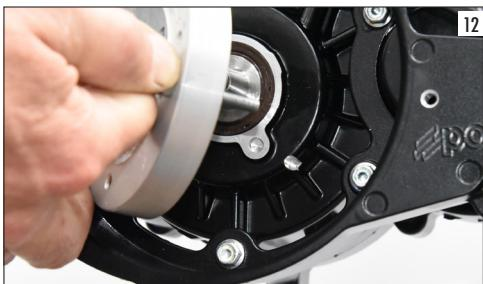
Visser l'écrou du volant sans le serrer de façon à ce que le vilebrequin puisse tourner dans le volant. Visser le support du comparateur dans le trou de la bougie, placer le comparateur et mettre le piston au PMS. Mettre à zéro le comparateur et tourner le vilebrequin dans le sens antihoraire de X mm en regardant du côté du volant (voir flèche, photo 13).
