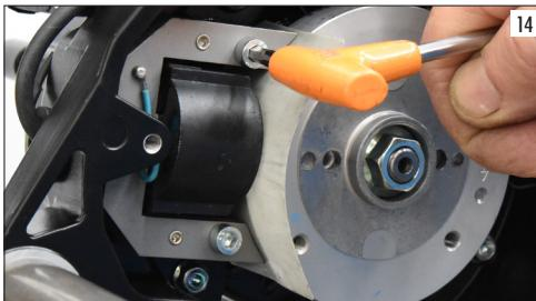
Procedere al bloccaggio definitivo del dado volano utilizzando una chiave dinamometrica a 40 Nm. (foto 15).
