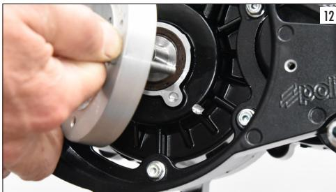
Avvitare il dado del volano senza bloccarlo in modo tale che l'albero motore possa girare nel volano. Avvitare nel foro della candela il supporto del comparatore, posizionare il comparatore e portare il pistone al punto morto superiore. Azzerare il comparatore e ruotare l'albero motore in senso antiorario di X mm guardando dal lato volano (vedi freccia foto 13).
