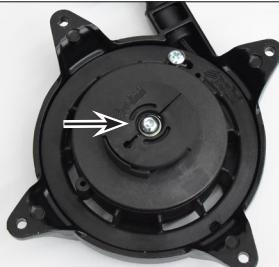
**ATTENTION!** Sous le couvercle il y a deux doigts d'embrayage démarreur (en vérifier l'usure et, si nécessaire, les remplacer) et, au dessous, il y a deux ressorts de dimensions réduites. Prêter attention pour éviter de perdre ces composants.
