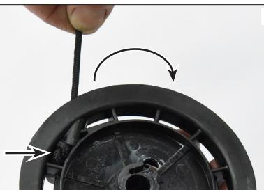
A ce moment-là insérer toute la roue en plastique dans son siège en vérifiant par le trou que le crochet intérieur du ressort soit parfaitement accroché (photo 8), repositionner les ressorts, les doigts d'embrayage de démarrage et revisser le couvercle en utilisant du frein filet moyen.
